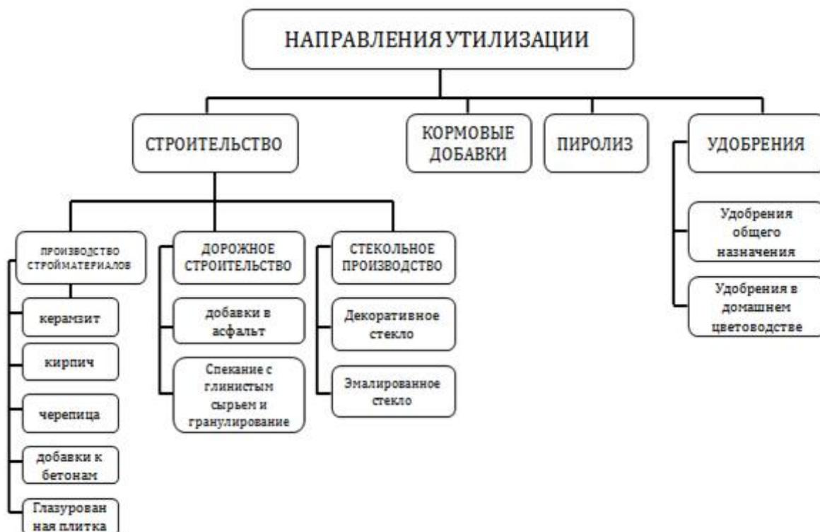
Рисунок 4 – Возможные пути утилизации осадков сточных вод.
