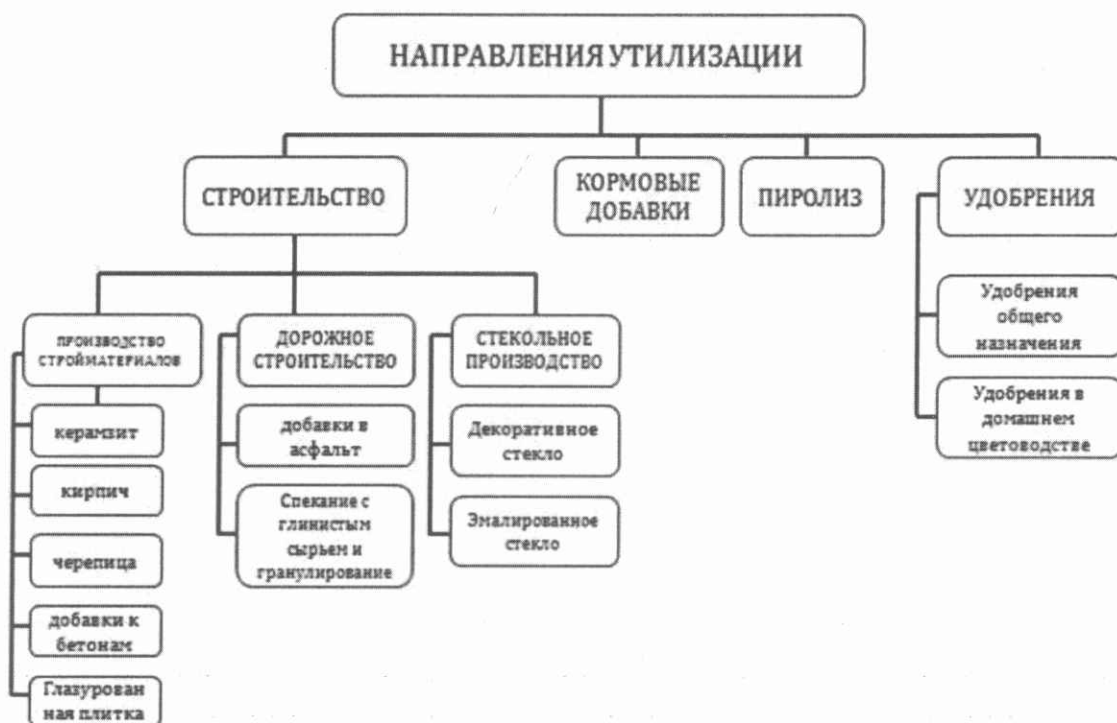
Рисунок 4 – Возможные пути утилизации осадков сточных вод.
